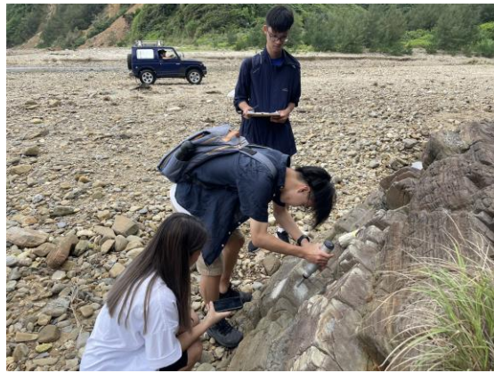
學生利用施密特 (sclerometer) 測量岩層硬度及利用傾斜儀測量岩層坡度
